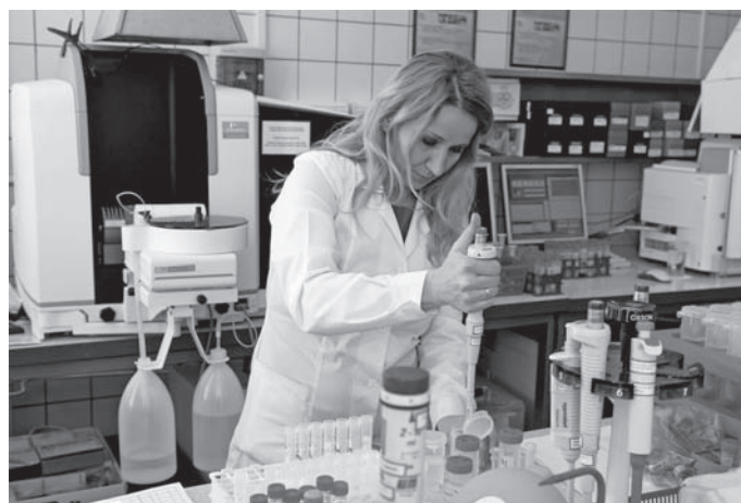
Рис. 2. Для определения тяжелых металлов используются высокочувствительные спектральные методы, в частности электротермическая атомно-абсорбционная спектрометрия
