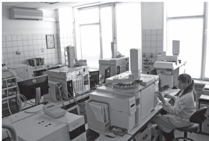
Рис. 3. Определение широкого перечня органических веществ в воде обеспечивают современные методы газовой и жидкостной хроматографии
