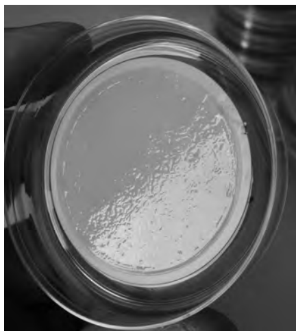
Рис. 2. Сливной рост на всей поверхности фильтрации МФ.
