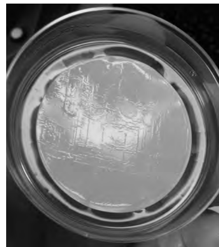
Рис. 4. Вариант сливного роста на мембране с характерным линейным рисунком.
