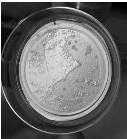
Рис. 3. Сливной рост на части поверхности фильтрации МФ.
